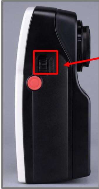
Per cambiare la posizione della lente su uno strumento a doppia apertura utilizzare l'interruttore sul lato dello strumento accanto al pulsante Misurazione (measure).
